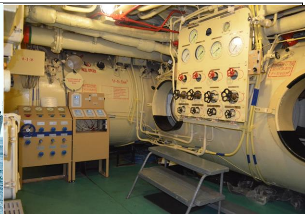
Один из элементов переоборудованной СЖО барокамеры спасательного судна «ЭПРОН»
